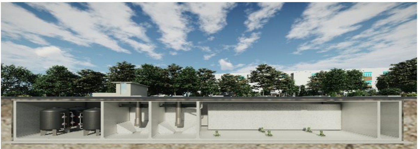
Trạm xử lý nước thải sinh hoạt công suất 2.000m 3 /ng.đ thuộc Dự án Khu Đô thị Cát Tường Phú Sinh
